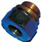
Raccord à compression de radiateur droit en laiton nickelé de ½ po pour le cuivre (Utilise les connecteurs pour le cuivre G3/4 X ½", pièce n° V-1627616, compris). Le tuyau chromé modèle n° V-C16600 peut être utilisé
