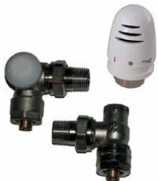
Ensemble de robinets à commande thermostatique à angle inversé de ½ po en laiton nickelé pour un raccordement au PEX de ½ po. Ce modèle de robinet permet de monter la tête thermostatique à la verticale sur le côté droit du radiateur. (Utilise les raccords pour le PEX G3/4 X ½", pièce n° V-1609803, compris)
