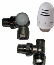
Ensemble de robinets à commande thermostatique à angle inversé de ½ po en laiton nickelé pour un raccordement à un tuyau de cuivre de ½ po. Ce modèle de robinet permet de monter la tête verticalement sur le côté gauche du radiateur. (Utilise les raccords pour le cuivre G3/4 X ½", pièce n° V-1627616, compris). L'ensemble de robinets comprend :
