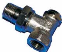
Robinet de retour Lockshield en laiton nickelé à filetage ½ po NPT coudé utilisé pour le sectionnement et l'équilibrage du débit
