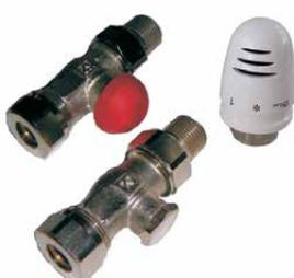
Ensemble de robinets à commande thermostatique en laiton nickelé droits de ½ po pour le raccordement à compression à un tuyau en cuivre de ½ po. (Utilise les raccords pour le cuivre G3/4 X ½", pièce n° V-1627616, compris). Le tuyau chromé modèle n° V-C16600 peut être utilisé. **L'ensemble de robinets comprend :**
