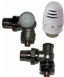
Ensemble de robinets à commande thermostatique à angle inversé de ½ po en laiton nickelé pour un raccordement au PEX de ½ po. Ce modèle de robinet permet de monter la tête thermostatique à la verticale sur le côté gauche du radiateur. (Utilise les raccords pour le PEX G3/4 X ½", pièce n° V-1609803, compris).
