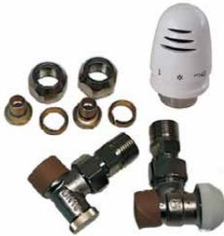
Ensemble de robinets à commande thermostatique en laiton nickelé coudés de ½ po pour le raccordement à un tuyau PEX de ½ po. (Utilise des raccords à compression pour le PEX M22 x ½", pièce n° V-1606603, compris).
