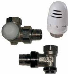
Ensemble de robinets à commande thermostatique à angle inversé de ½ po en laiton nickelé pour un raccordement au filetage NPT de ½ po. Ce modèle de robinet permet de monter la tête thermostatique à la verticale sur le côté gauche du radiateur.
