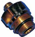
Connecteurs à compression de radiateur droit en laiton nickelé de ½ po pour PEX (Utilise les connecteurs pour le cuivre G3/4" X ½", pièce n° V-1609803, compris).
