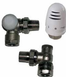
Ensemble de robinets à commande thermostatique à angle inversé de ½ po en laiton nickelé pour un raccordement à un tuyau de cuivre de ½ po. Ce modèle de robinet permet de monter la tête à la verticale sur le côté droit du radiateur. (Utilise les raccords pour le cuivre G3/4 X ½", pièce n° V-1627616, compris). L'ensemble de robinets comprend :
